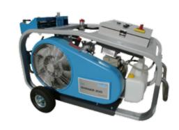
写真 4-5 災害時に現場で使用する空気ボンベへの充填機を 可搬式に更新します
